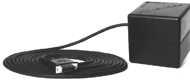
Abb. 5: Der Sender des elektromagnetischen Trackingsystems FASTRAK.
