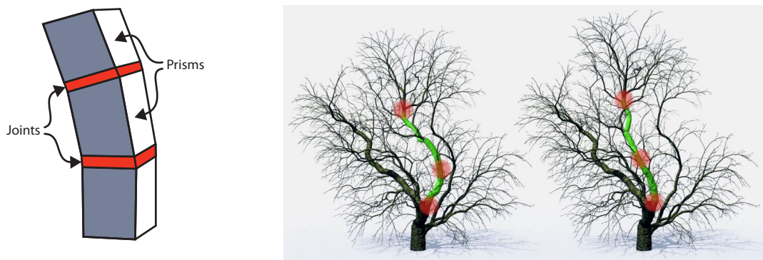
Abbildung 13: links: Prismen verbunden durch elastische Gelenke, rechts: Verschiebung eines Astes mit einer 3-Finger-Geste (aus [1])
