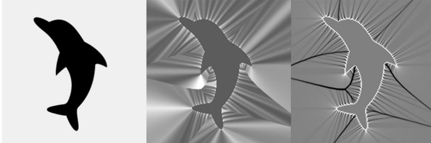
**Abbildung 7:** Links: Vorlage. Mitte: Fehler der euklidischen Abstandstransformation gegenüber dem Abstand zur perfekten Form, mittleres Grau steht für keinen Fehler. Rechts: Differential der euklidischen Abstandstransformation.
