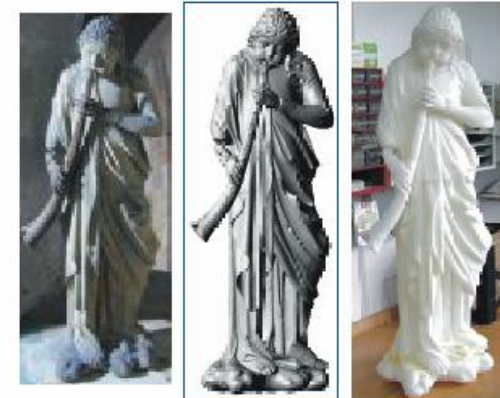
Original rekonstruiertes Dreiecksnetz Kunststoff-Kopie
