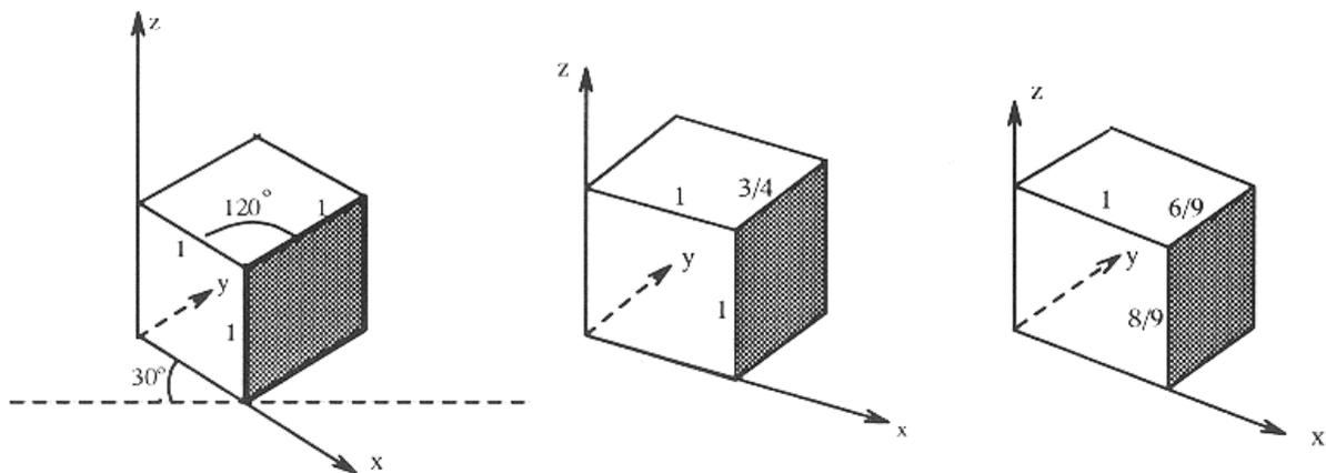
links: isometrische Projektion eines Würfels, Mitte: dimetrische Projektion (selber Verkürzungsfaktor entlang der x- und der z-Achse), rechts: trimetrische Projektion. Aus Rauber (1993).
