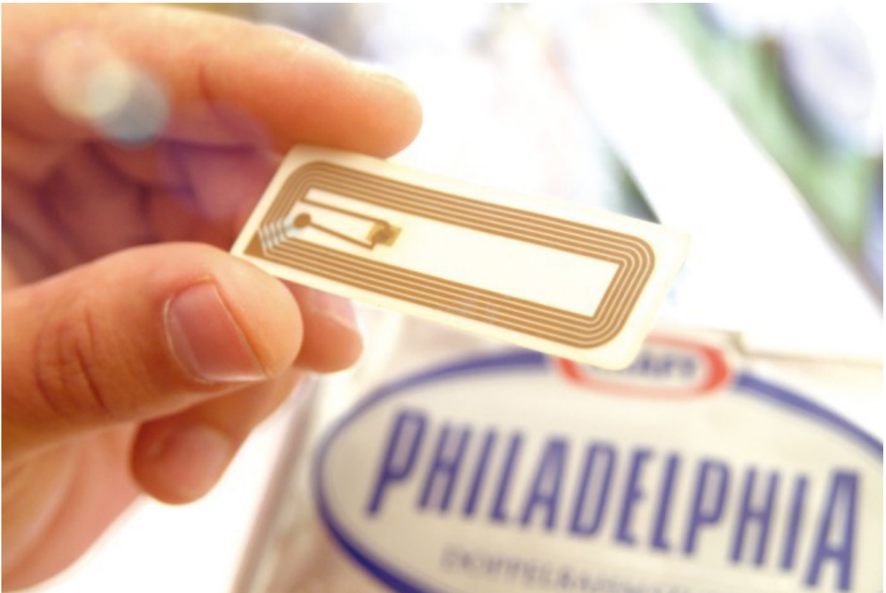
RFID-Tag für Produktmarkierung (Bar Code Ersatz)
