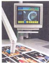
Registriersteuerung mit Videokuppe
