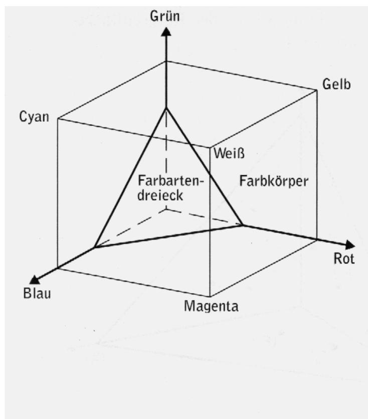
Je weiter die Farborte der Grundfarben vom Nullpunkt entfernt liegen, desto größer ist das Volumen des so gebildeten quaderförmigen Farbkörpers und damit die Qualität des auf ihm basierenden Farbreprosystems.
