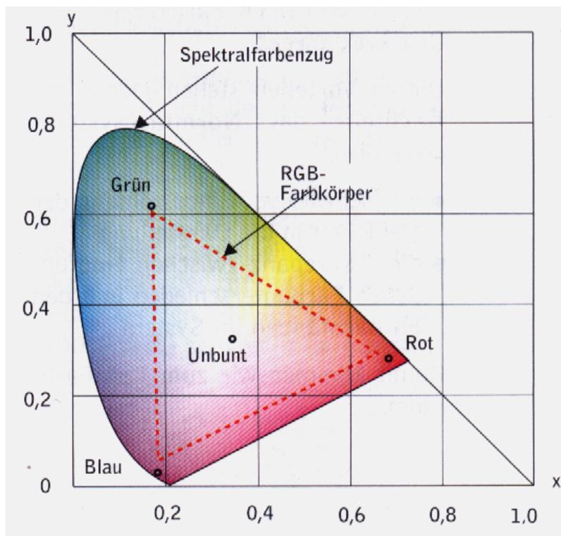
Grundfarben eines Reproduktionsgerätes bilden ein Dreieck innerhalb der "Schuhsohle"
