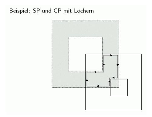
Durch Markierungen muss sichergestellt werden, dass kein Pfad zweimal durchlaufen wird.
