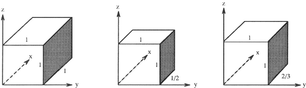
Darstellung eines Einheitswürfels mit schiefwinkliger Parallelprojektion. Links: Kavalierprojektion, Mitte: Kabinettprojektion, rechts: Variante mit  $56^\circ$ -Winkel der Projektionsstrahlen, entsprechend einer Verkürzung von  $2/3$  (liefert oft natürlicheres Bild).
