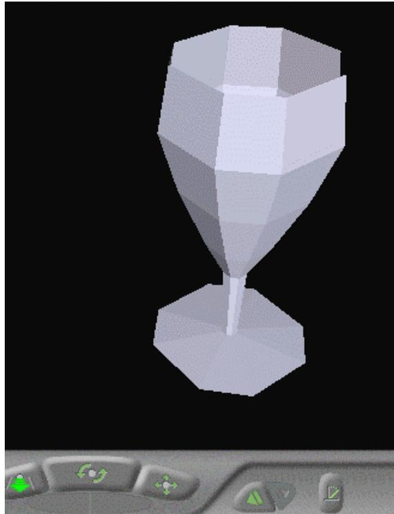
Modifikation: Drehung während der Extrusion
