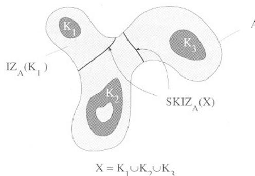
Die *Wasserscheidentransformation* (watershed transform) eines Grauwertbildes  $B$  verläuft anschaulich so, dass das "Grauwertgebirge"  $B$  von den lokalen Minima aus "geflutet" wird. An den Stellen, wo in diesem Flutungsprozess 2 Wasserbecken (catchment basins) zusammenstoßen, werden 1 Pixel-dünne Dämme errichtet.
