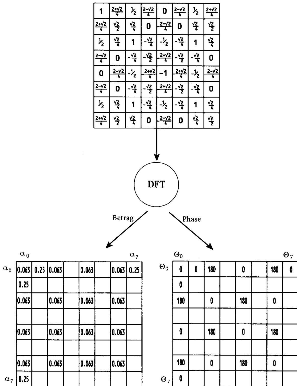
hier kann das "ungestörte" Signal leicht rekonstruiert werden durch Entfernen der "kleinen" Beträge (0.063) aus dem Spektrum!
