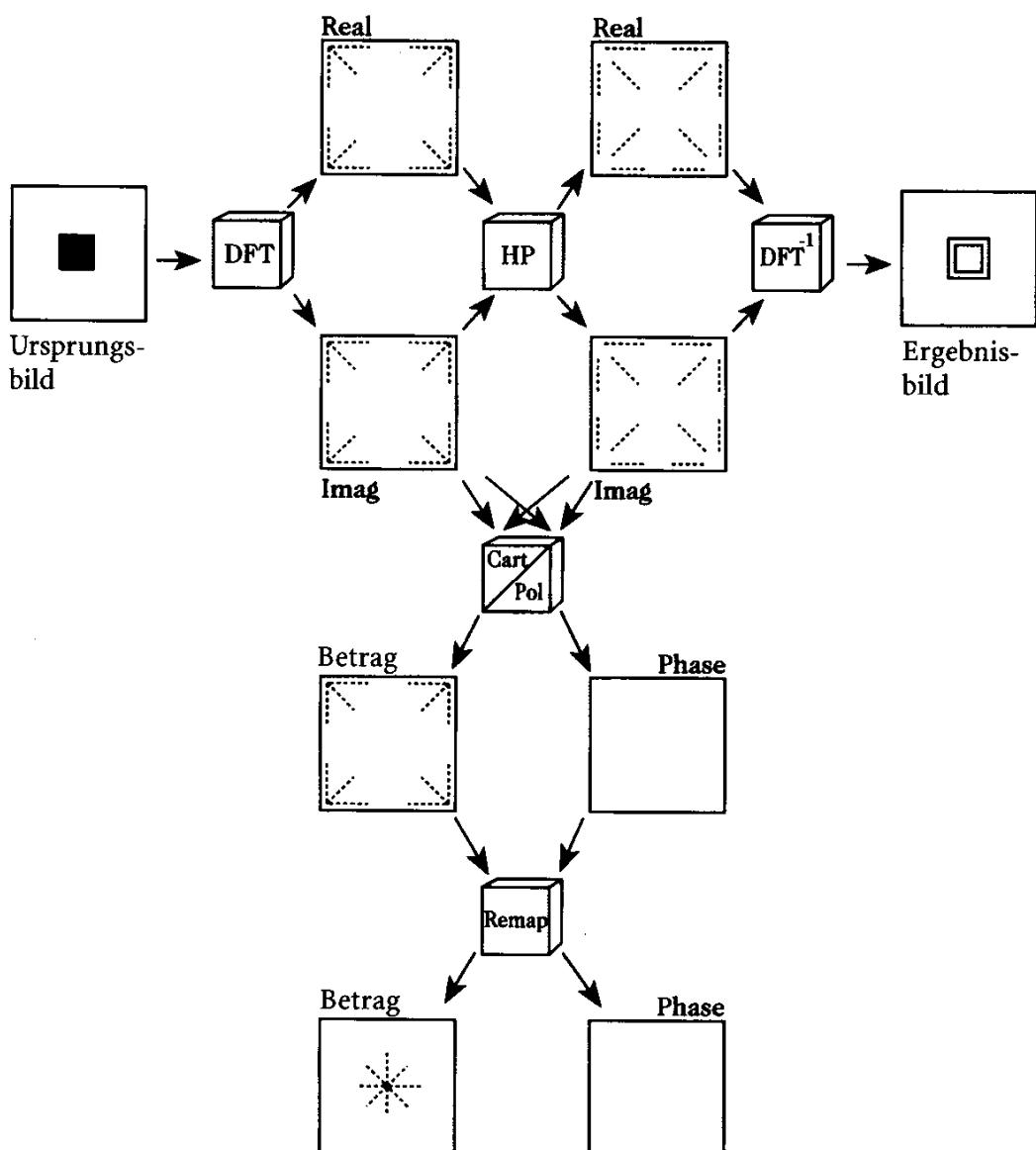
Beispiel einer kompletten Hin- und Rücktransformation (ohne Manipulation), durchgeführt mit DBS-AdOculos (Setup-Datei **glofou.set**):
